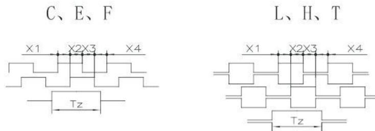
本图为从编码器输出轴方向看顺时针 (CW) 旋转的波形
